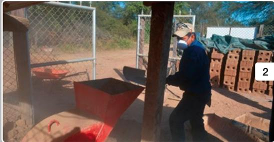
3. Adición del cemento a la arcilla, proporción 1:7 (1 parte de cemento y 7 partes de arcilla molida).
