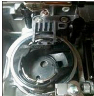
Figura 16: Limpieza de dientes y bobina
