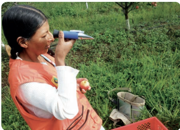
Medición del contenido de azúcar de manzana con refractómetro
